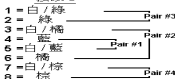
EIA/TIA 568A/B 規範 RJ-45 接頭製作標準說明圖
