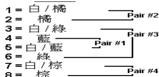
EIA/TIA 568A/B 規範 RJ-45 接頭製作標準說明圖
