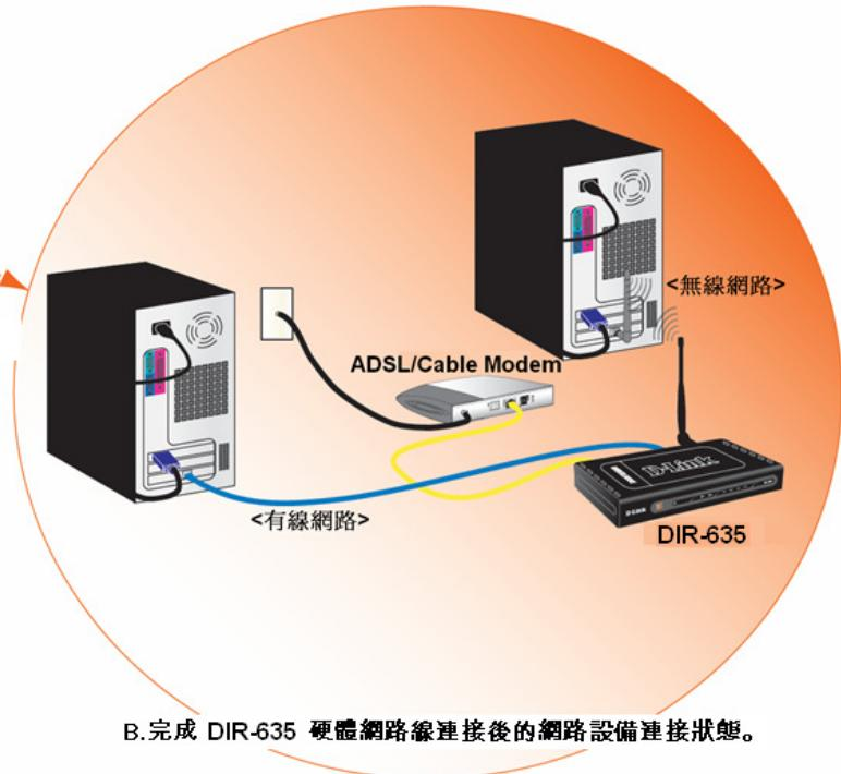
B. 完成 DIR-635 硬體網路線連接後的網路設備連接狀態。
