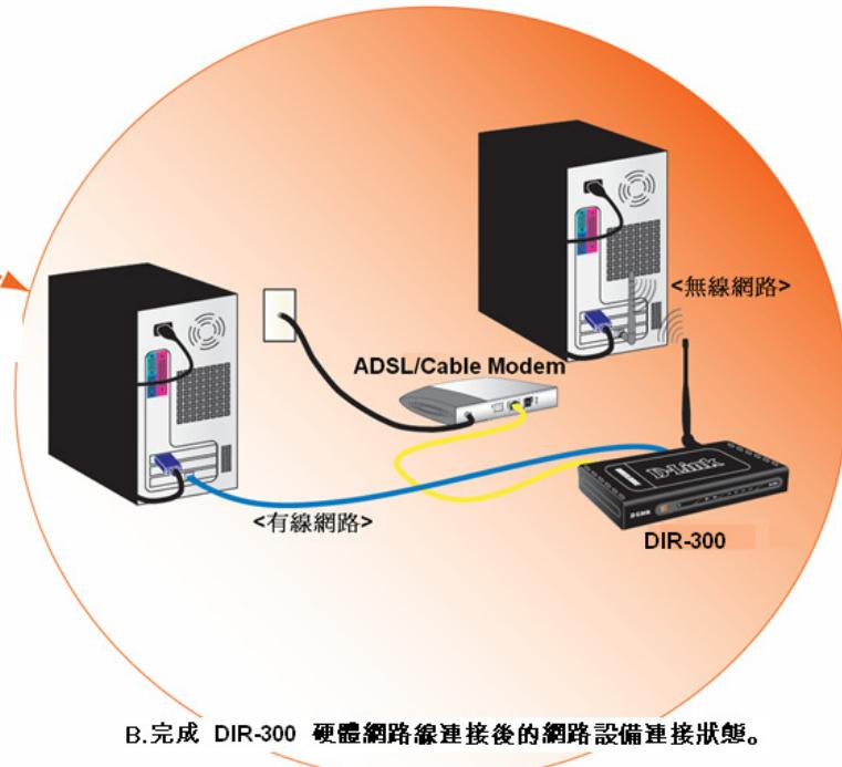
B. 完成 DIR-300 硬體網路線連接後的網路設備連接狀態。
