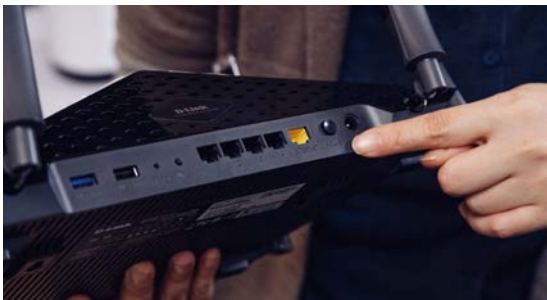
▲D-Link DIR-890L搭載的Lan埠與Wan埠皆支援Gigabit的速度，實際測試Lan埠的確能達到300M以上的速度；至於Wan的部分若要達到同樣速度，就必須要有相對應的無線網卡支援才行
